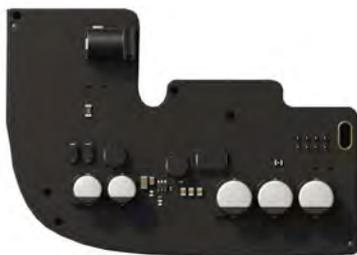
Le bloc d'alimentation est compatible avec le panneau de commande du Hub 2. Il est équipé d'une prise standard qui permet de connecter une prise d'alimentation et d'un adaptateur de terminal groupé. Le bloc d'alimentation 12 V se loge dans le boîtier de l'appareil, remplaçant le bloc d'alimentation 110/230 V préinstallé.
