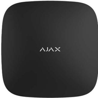
Hub 2 Plus réduit la connexion à l'absolu. Il dispose de 4 canaux de communication dont le réseau LTE à haut débit. Cette configuration vous permet de connecter le dispositif à deux fournisseurs Internet distincts tels que Ethernet et Wi-Fi, tout en ayant deux réseaux cellulaires prêts pour la sauvegarde. La commutation entre les canaux se fait sans interruption en quelques secondes.
