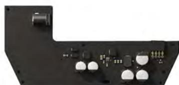
Le bloc d'alimentation est compatible avec Hub, Hub Plus et ReX. Il est équipé d'une prise standard qui permet de connecter une prise d'alimentation et d'un adaptateur de terminal groupé. Le bloc d'alimentation 12 V PSU se loge dans le boîtier de l'appareil, remplaçant le bloc d'alimentation 110/230 V préinstallé.
