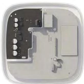
Le bloc d'alimentation 12 V se loge dans le boîtier de l'appareil, remplaçant le bloc d'alimentation 110/230 V préinstallé.
