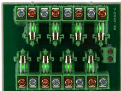
Triple protection électronique PTC en sortie utilisateur
